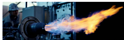
水素バーナ燃焼試験
